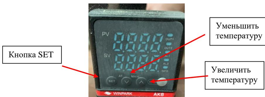
Для установки нужной температуры нажмите кнопку «SET». Нижний показатель – это установленная температура нагревания. При мигании данного показателя Вы можете устанавливать нужную Вам температуру (при помощи кнопок AT ↓ или MAN ↑). После этого вновь нажмите кнопку SET – процесс нагревания начнется.
